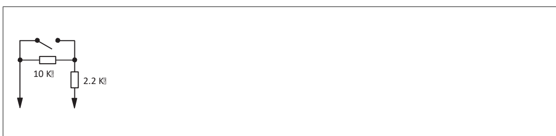
Рисунок 3.15 Эквивалентное сопротивление NAMUR
