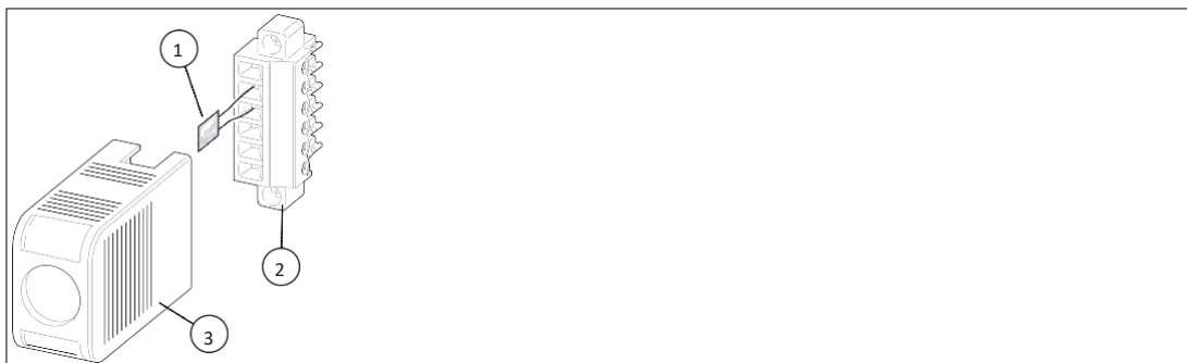
Рисунок 3.16 Крышка и модуль компенсации холодного спая для измерения термопарой с использованием модулей ввода-вывода 5x02
