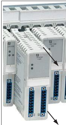
Рисунок 3.8 Удаление модуля из распределительных плат с LB9022 по LB9029
